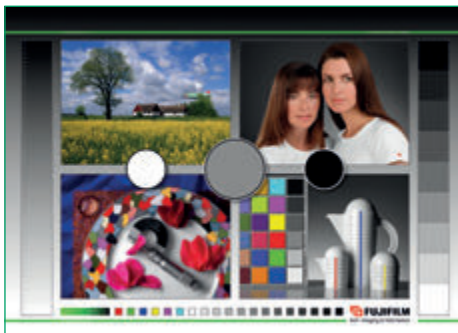
TESTBILDER UND TESTCHARTS Die Testbilder und Testcharts enthalten sowohl visuell als auch messtechnisch auswertbare Elemente. Die Motive erlauben eine umfassende Bildanalyse. Die einzelnen Messfelder haben definierte Werte für die messtechnische Auswertung. Alle Testbilder/Charts: Fujifilm/Jens Rubbert.
