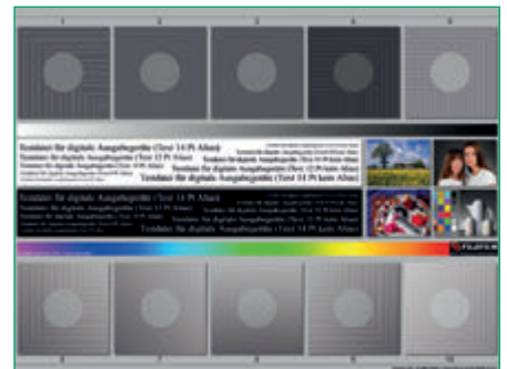
TESTBILDER UND TESTCHARTS Die Testbilder und Testcharts enthalten sowohl visuell als auch messtechnisch auswertbare Elemente. Die Motive erlauben eine umfassende Bildanalyse. Die einzelnen Messfelder haben definierte Werte für die messtechnische Auswertung. Alle Testbilder/Charts: Fujifilm/Jens Rubbert.
